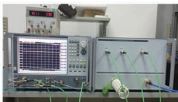
图9 故障定位测试系统及校准环境
